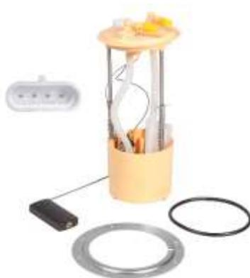
**Топливный насос электрический** – электрический насос погружного типа, центробежный. Является исполнительным элементом топливной системы автомобильного двигателя и составной частью топливного модуля. Представляет собой электродвигатель с насосным узлом, изготовленным в одном корпусе.
