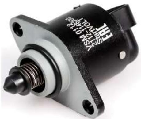
Регулятор холостого хода предназначен для регулирования частоты вращения коленчатого вала двигателя внутреннего сгорания автомобиля при закрытой дроссельной заслонке (в режиме «холостого хода» работы двигателя). Регулятор холостого хода работает в составе электронной системы управления двигателем. Регулятор холостого хода представляет собой шаговый электродвигатель, на конце штока электродвигателя закреплен затворный клапан конусной формы определенного размера.
